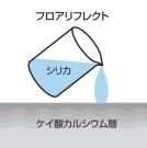
硬質化したコンクリートの表面に シリカ粒子が固着
