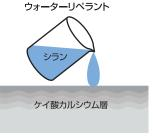
緻密化したコンクリートの微細な 空隙に撥水成分が含浸
